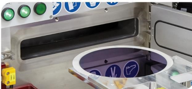
Manuelle Vorrichtung zum Be- und Entladen von 200-mm-Wafern. Das System ist vorbereitet für den Einbau in ein Clustersystem mit einem zentralen Transferrobotermodul, Lastschleusen und weiteren Prozessmodulen.
